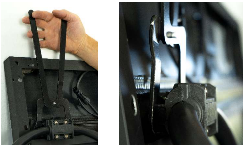
Figure 29 : Démontage des raccords hydrauliques DualQuickfit
