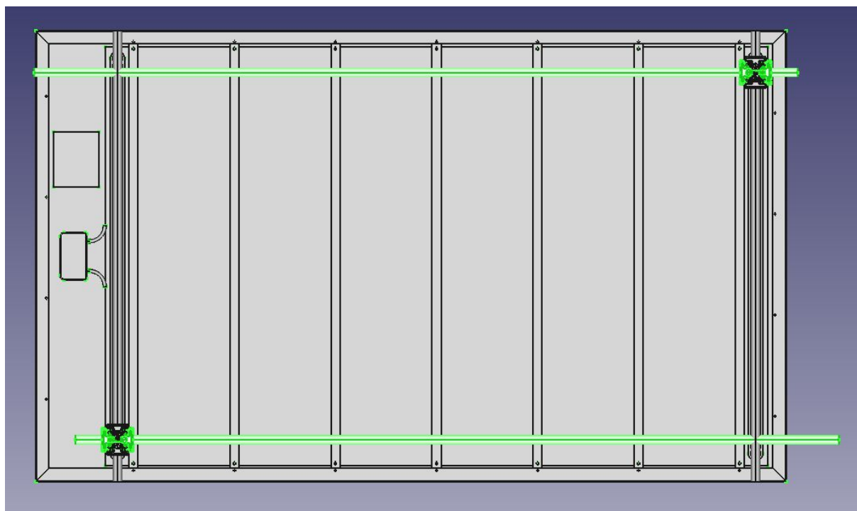
Figure 13 : Configuration de pose 3 – Panneau en paysage / Liaison en paysage
