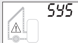
Sur l'écran du régulateur clignotent « SYS » et l'affichage d'avertissement
